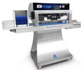
Посыпщик для декорирования форм под шоколадные плитки разных размеров на линии TUTTUNO или Mould Loader 175.
