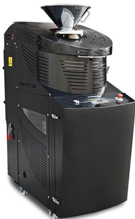
**Roaster 106** был разработан для работы в непрерывном цикле автоматической обработки. Имеет **бак** емкостью **6 кг** и предлагает возможность поджаривания **до 40 кг / ч** кофе или сушки сухофруктов.
